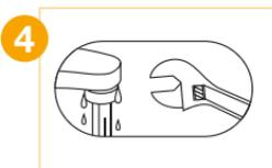
4. Abra la llave. Si el aireador gotea, apriételo utilizando la llave ajustable. Utilice la tela para proteger el acabado. Apriete hasta que quede ajustado. **NO APRIETE DEMASIADO.**
